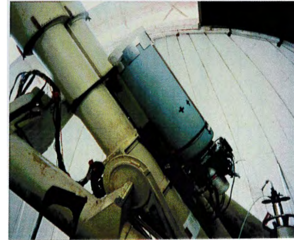
Le T40 t lescope, cam ra 16 CCD, cryostat et  lectronique
